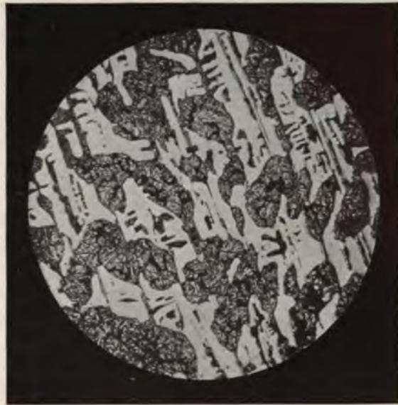
Fig. 152. Weißes Roheisen, abgeschreckt. Große weiße Felder: Cementit. Schwarze Knoten: Troostit. Grundmasse: Austenit-Martensit.
